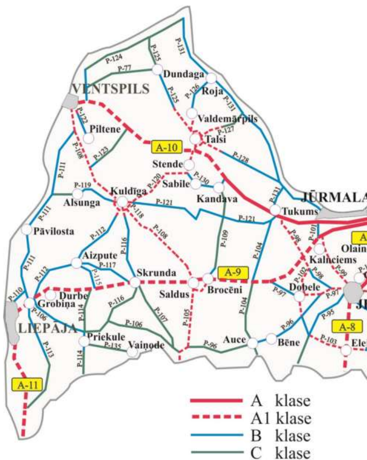
92.attēls Valsts galveno un reģionālo autoceļu uzturēšanas klases Kurzēmē 2015./2016. gada ziemā (LVC karte)
