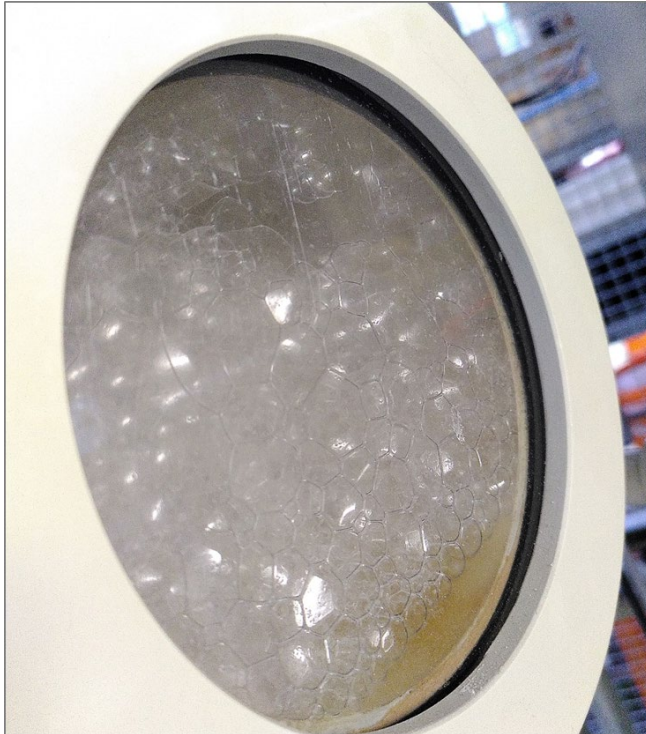
Schaumbildung während des Prozesses (l.), Niederschlagsbildung während Eindampfung (m.), Mischsalz aus \text{Na}_2\text{SO}_4/\text{NaCl} (r.)
