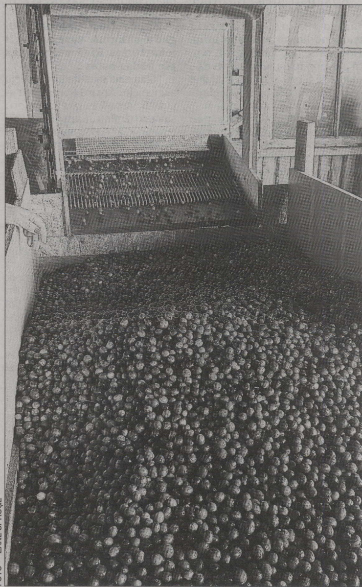
TĪRĀMĀ MAŠĪNA. Tā ir pirmā no agregātiem, ko saimniecībā nopirka, lai samazinātu roku darbu. Iekārta atsijā abortējušās ogas, zariņus un lapas, sietam cauri tiek vien retā.
