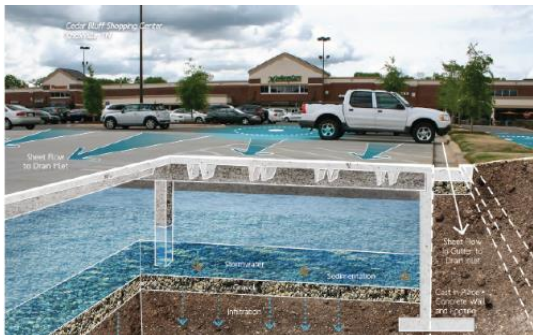
37. attēls. Ilgtspējīgas lietus ūdens apsaimniekošanas risinājumi: infiltrācijas sistēmas.
